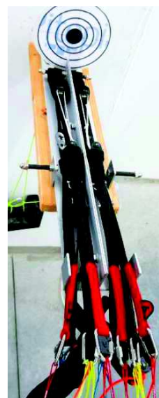
Einspannung der Tragegurte für die Laservermessung
