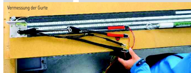
Einspannung der Tragegurte für die Laservermessung
