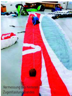
Vermessung der Hinterkante
