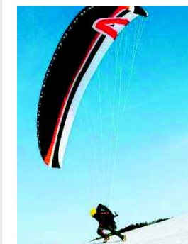
Bild 9: Viel Vorlage für einen schnellen Startlauf bei wenig Wind. Kein Start bei deutlichem Rückenwind. Wenn der Startplatz bei wenig Wind flach ist, muss man sehr schnell laufen und bremst nur gering an, um abzuheben. Wer hier ruckartig stark bremst, riskiert durch das Pendeln ein nochmaliges Aufsetzen.
