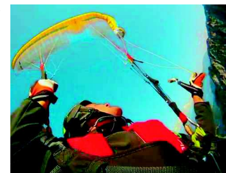
Lösungsversuch mit der Stabiloleine. Flugrichtung stabilisieren und Verhänger lösen gestaltet sich in der Praxis oft schwieriger als in der Theorie. Im Zweifelsfall den Notschirm auslösen!
