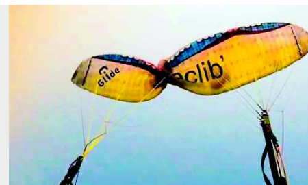
Bild 3 | Das Bonbon. Meist ausgelöst durch einen Leinenüberwurf. In sehr seltenen und extremen Situationen kann es auch vorkommen, dass sich der gesamte Schirm einmal in sich verwindet. Ist diese Störung im äußeren Drittel des Flügels, kann das Problem mittels eines seitlichen Einklappers gelöst werden. Achtung: Auf keinen Fall die Stabiloleine ziehen. Das Problem kann sich damit verschlimmern!
