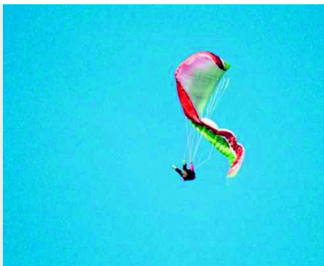
Vollbeschleunigter seitlicher Einklapper mit einem EN-C Gerät.
