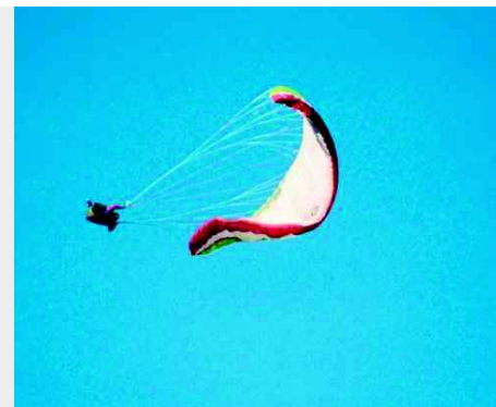
Ist die Entlastung auf der zuvor offenen Seite so groß, kann es auch zu derartigen Einklappern führen. In diesem Fall hatte es wieder die positive Eigenschaft des Abbremsens.
