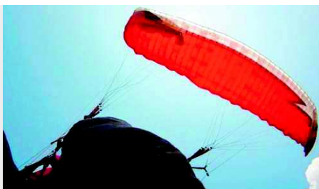
Bild 1 | Verhänger von vorne kommend. Beste Lösungsmöglichkeit für einen derartigen Verhänger ist die Stabiloleine. Für Könner ist auch der Fullstall eine Alternative.
