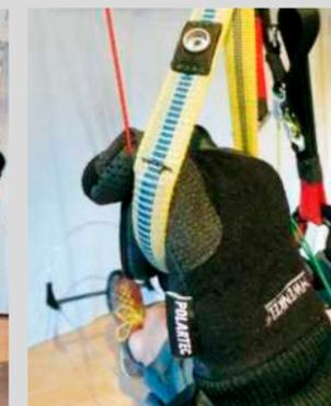
5 | Die Steuerleine kann bei diesem Manöver selbstverständlich auch in der Hand gelassen werden. Sie sollte aber in der Normalstellung gehalten werden, um den Gleitschirm nicht zusätzlich zu verlangsamen.
