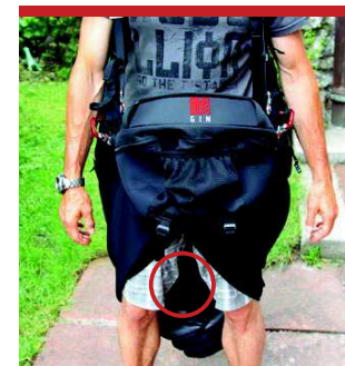
Abbildung 4: Genie Race mit offenen Gurtverschlüssen, aber geschlossener „Schürze“ des Beinsacks und eingehängtem Front-Cockpit. Das eingehängte Cockpit verstärkt zusätzlich den Eindruck, alles sei ordnungsgemäß verschlossen. Und zwar für den Piloten ebenso, wie für einen Dritten, der einen kontrollierenden Blick auf das Gurtzeug wirft. Das offene Verschluss-System, es befindet sich im Beinsack (roter Kreis), bleibt unbemerkt.
