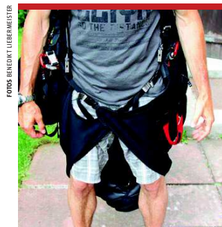
Abbildung 3: Genie Race mit offenen Gurtverschlüssen, aber geschlossener „Schürze“ des Beinsacks. Die relativ eng anliegende Neoprenschürze vermittelt dem Piloten das Gefühl, kompakt mit dem Gurtzeug verbunden zu sein, auch dann, wenn das Verschluss-System vollständig offen ist. Der Pilot auf dem Bild, ein erfahrener Streckenflieger, konnte bei geschlossener Schürze nicht spüren, ob das Gurtsystem offen oder geschlossen war.
