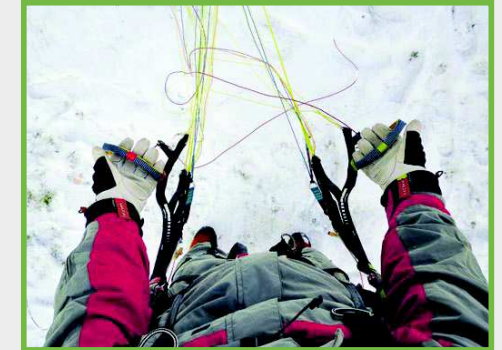
(4) Die Tragegurte hängen seitenrichtig vor einem nach unten. Der entscheidende Trick ist, jetzt die Steuer-schlaufen mit den Händen aufzunehmen und in der jeweiligen Hand zu belassen. Die Rechte (grün) in der rechten Hand und die Linke (rot) in der linken Hand.
