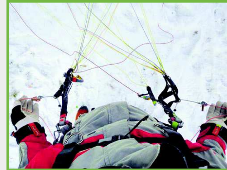
(3) Jeweils die Beschleuniger-Brummelhaken von unten wir unverdreht verbinden.
