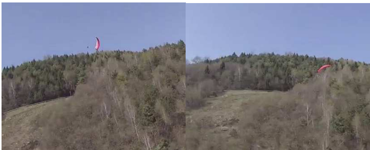
Abbildungen 2, 3: Standbilder aus dem GoPro-Video: Der Tequila 2 in der Trudelbewegung (links) und beim Vorschießen aus dem Trudeln unmittelbar vor dem Aufprall (rechts).
