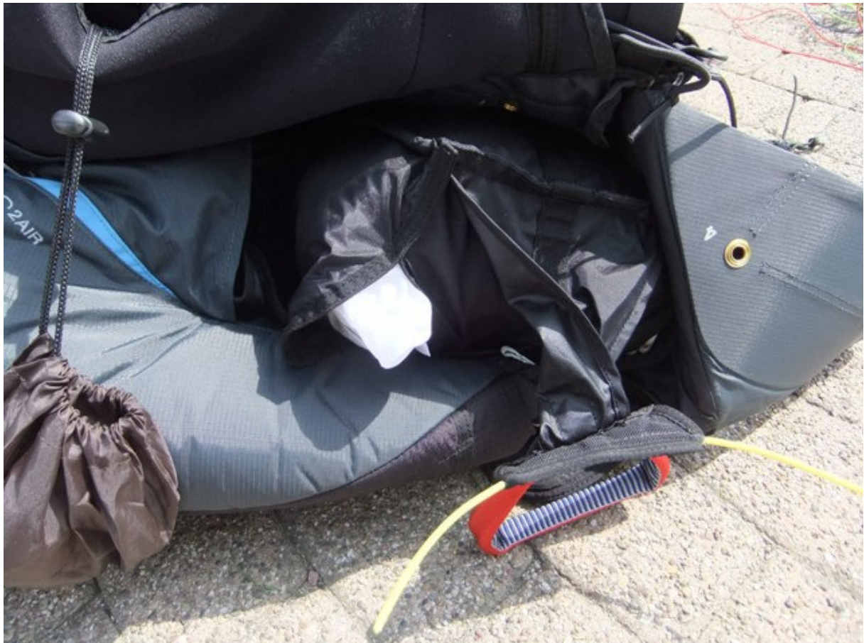
Abbildung 1: Zustand des Rettungsgerätes nach den Erste-Hilfe-Maßnahmen. Der Griff aus seiner Arretierung abgezogen, der Außencontainer offen, der Rettungsschirm nicht ausgelöst.
