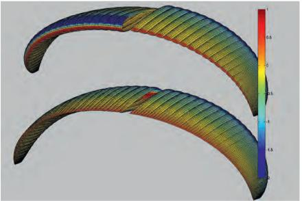
Abbildung 4: Druckverteilung 50-Zeller
