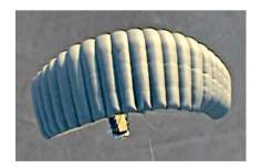
Abbildung 2: Starke Deformation der Hinterkante aufgrund ballooning
