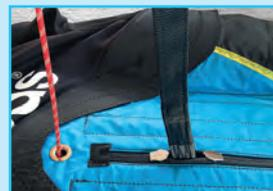
Die Hauptaufhängung muss auf Scheuerstellen untersucht werden.
