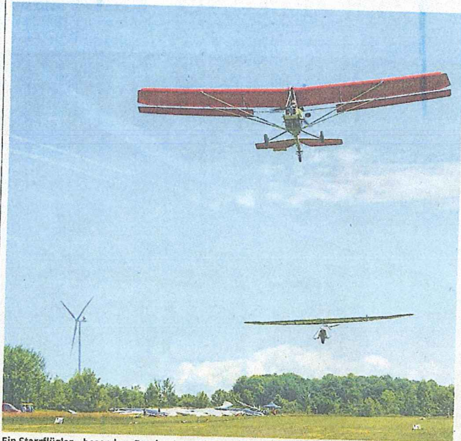
Ein Starrflügler – besondere Drachenart – wird vom Ultraleichtflugzeug auf Höhe geschleppt.
