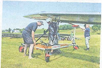
Vor dem Start: Der Pilot des Starrflüglers legt sich auf den Startwagen.
