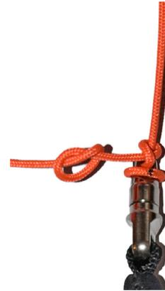
Jetzt mache den zweiten Sicherungsknoten: Verknote noch einmal den überstehenden Teil der Steuerleine und führe den Knoten ganz nah an den Bremswirbel dran. Fertig!
