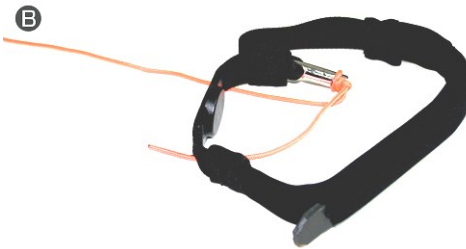
Zum Herausnehmen der Verstärkung, Duogrip-Brmsgriff auf links drehen und das Stäbchen durch die vorhandene Öffnung schieben
