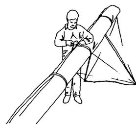
Ziehe die Spanngurte nur so fest, daß die Mylaranstömkante knickfrei zusammengeführt wird.
