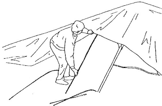
6. Der neue innovative Klappmechanismus (Flipback) ist zum Spannen der Segellatten äußerst praktisch, ist jedoch auch sehr empfindlich. Durch übermäßige Kraftaufwendung können die Schnapphäkchen abbrechen oder durch Abnutzung leichter aufgehen und müssen vor dem nächsten Flug ersetzt werden!
