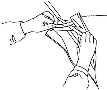
12. Schiebe die Untersegellatten in die vorgesehenen Öffnungen im Untersegel und fixiere sie gegen Herausrutschen.
