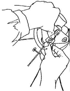
5. Die Segellatten (1 bis 7) werden jeweils von der Mitte nach außen eingeschoben; die restlichen Segellatten (Nr. 8 - 11) zur Vermeidung von Segelschäden, am besten erst nach dem Spannen der Randbögen und des Holms. Die Segellatten nur mit sanftem Druck einschieben um die Lebensdauer der Lattentaschen zu verlängern.
