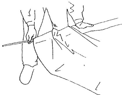
Stecke die Spannhebelhülse auf den Randbogen und lege den Hebel nach innen zum Randbogen hin um. Versichere Dich, daß dieser sauber eingerastet ist.
