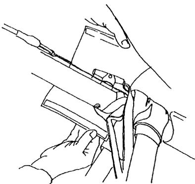
Beim Zusammenklappen achte darauf, dass Du das Segel zwischen Flügelrohr und Kiel nicht einklemmst.
