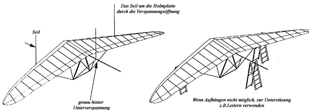
**Spanne nun einen Polyesterfaden straff zwischen den zu kontrollierenden Latten über das Kielrohr oder ggf. unter das Kielrohr. (siehe Abbildung )**
