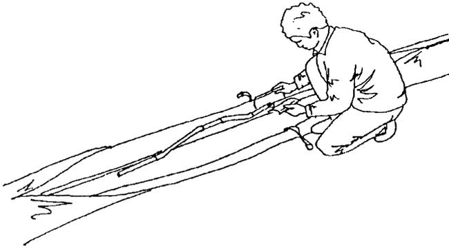
***Wichtig: Besondere Vorsicht ist bei den Verspannungsseilen geboten, da diese durch Knicke an Stabilität verlieren.***
