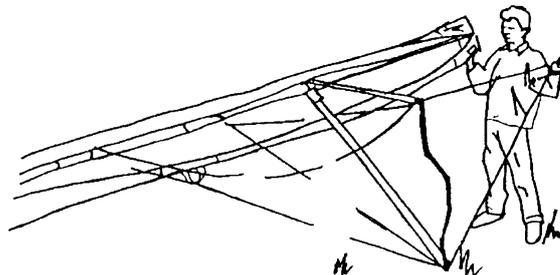
2. Entferne den Packsack und alle übrigen Gurte und Protektoren. Spreize jeden Flügel sorgfältig aus und achte darauf, daß Du sie nicht über das Kielrohr hebst. Vergewissere Dich, dass die Unterverspannungen nicht verdreht oder verhängt sind.
