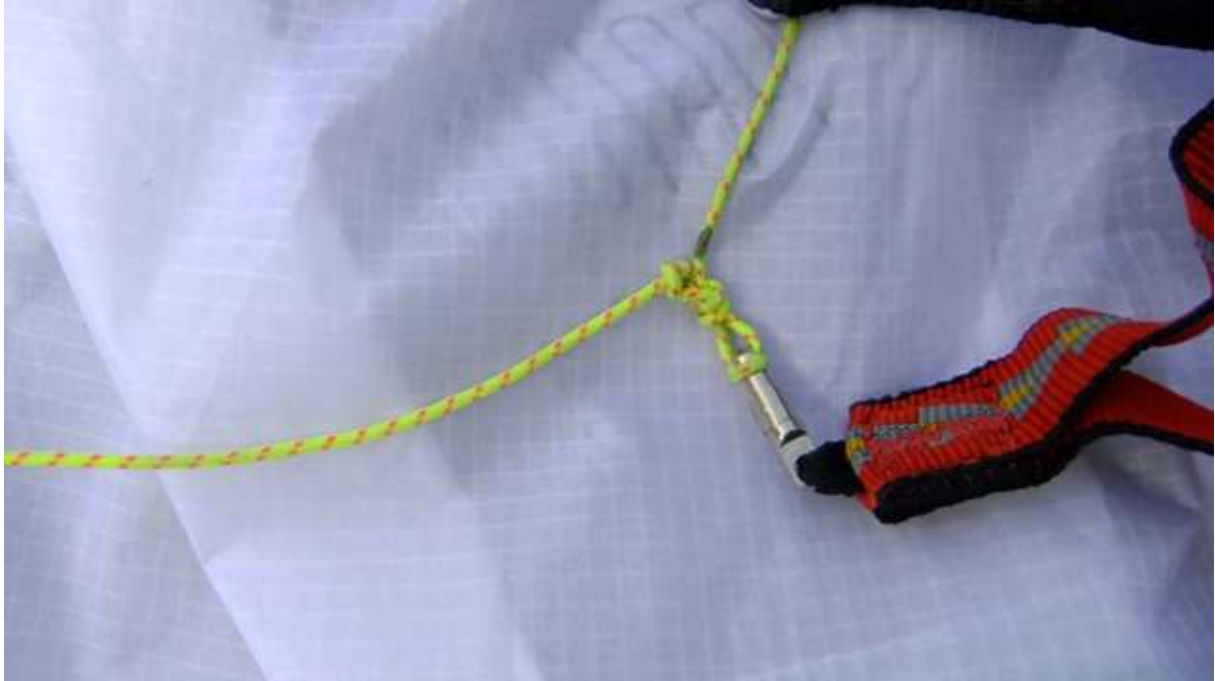
Abbildung 5: Einstellung der Steuerleinen an der Hersteller-Markierung
