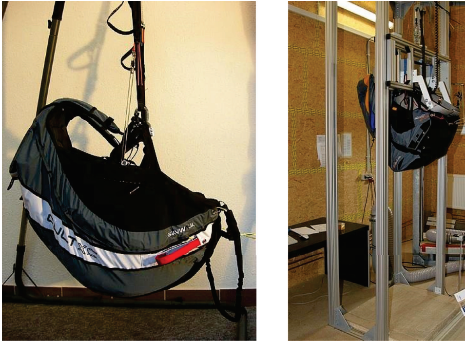
Abbildung 1.1: Gurtzeug Skywalk Cult XC [18] und Protektorprüfanlage des DHV [20]
