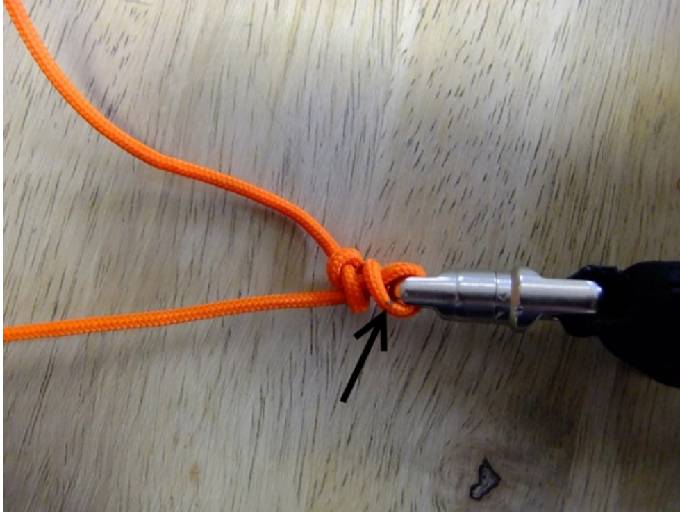
Abbildung 5: Original-Steuerleinebefestigung des Herstellers. Der verwendete Knoten ist von anderer Art, die Markierung (Pfeil) befindet sich im Bereich des Wirbels an der Steuerschlaufe.
