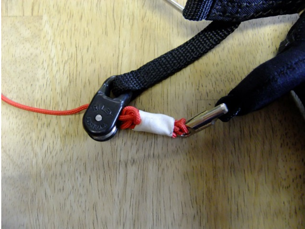
Abbildung 3: Die Steuerleinenbefestigung bei dem Unfallgerät
