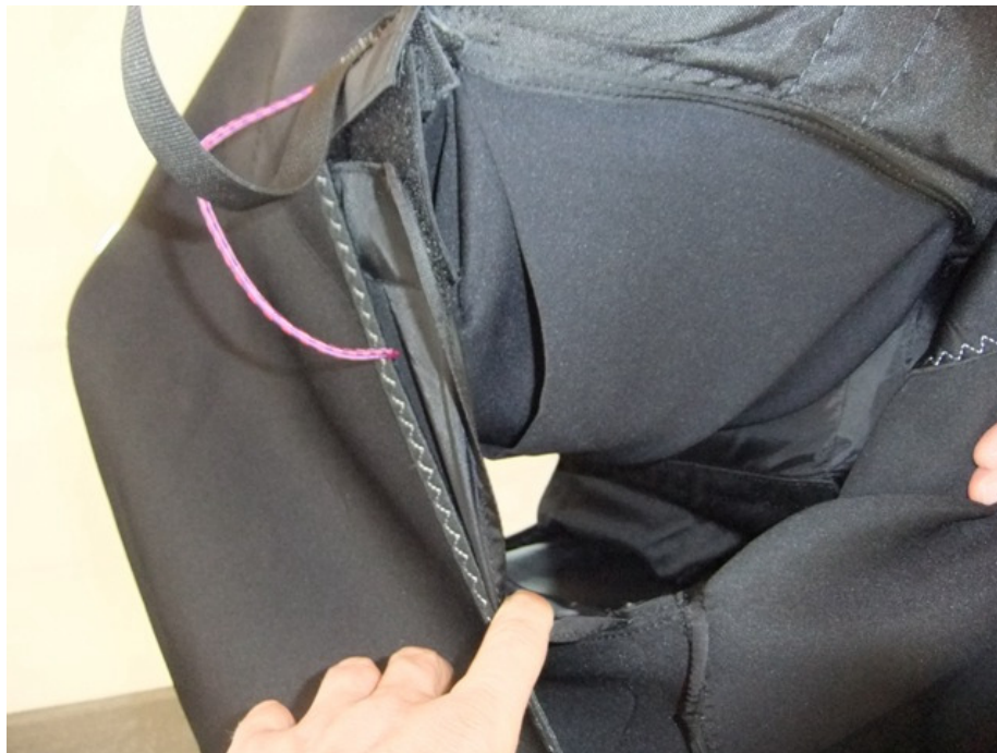
Abbildung 10: .... an der Gegenseite kontrollieren. Beim Kamasutra 2 ist es sehr einfach den ordnungsgemäßen Zustand des Rettungsgeräte-Containers zu überprüfen. Das wäre auch die Empfehlung für Piloten, die mit diesem Gurtzeug fliegen. Regelmäßig den Rettungsgeräte-Container kontrollieren, der an der linken Seite des offenen Beinsacks vollständig sichtbar ist. Denn absolut auszuschließen (durch irgendwelche Schiebe,- Schleuder,- Drehbewegungen) ist der Vorgang nach den Abbildungen 6, 7 und 8, wohl auch dann nicht, wenn der Retter ursprünglich korrekt eingebaut worden war.
