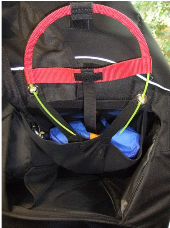
Abbildung 3: ... und diese gemäß Betriebsanleitung verschlossen wird, nämlich mit über Kreuz geführten Gurten zu den Splintern (Achtung, aus Demonstrationsgründen ist das letzte Außencontainer-Blatt auf den Abbildungen nicht verschlossen), konnte auch mit heftigsten Schüttel- und Schleuderbewegungen kein Herausrutschen des Retters aus der Neopren-Tasche erreicht werden. Weder mit sehr kleinem (Incase 95), noch mit einem voluminösen (U-Turn Protect III L) Retter.
