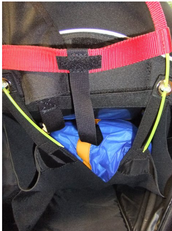
Abbildung 3: ... und diese gemäß Betriebsanleitung verschlossen wird, nämlich mit über Kreuz geführten Gurten zu den Splintern (Achtung, aus Demonstrationsgründen ist das letzte Außencontainer-Blatt auf den Abbildungen nicht verschlossen), konnte auch mit heftigsten Schüttel- und Schleuderbewegungen kein Herausrutschen des Retters aus der Neopren-Tasche erreicht werden. Weder mit sehr kleinem (Incase 95), noch mit einem voluminösen (U-Turn Protect III L) Retter.
