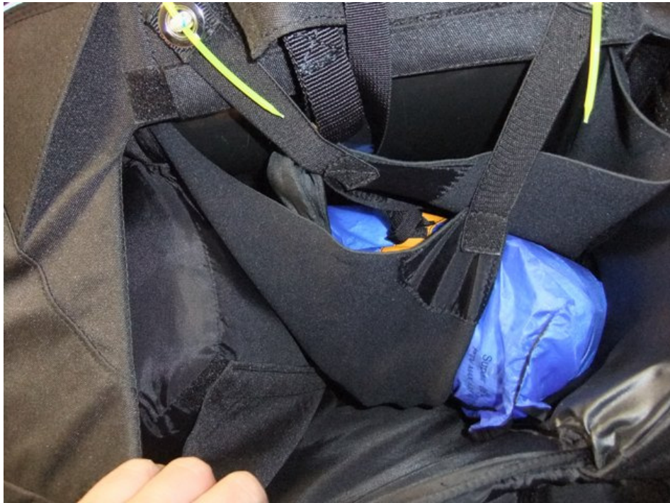
Abbildung 5: „Zuverlässig“ konnte ein Herausfallen in dieser Konfiguration erreicht werden: Die Verschluss-Gurte werden zwar über Kreuz zu den Splinten geführt, der Retter aber nicht symmetrisch in beide Hälften der Neopren-Tasche eingeführt sondern nur einseitig.
