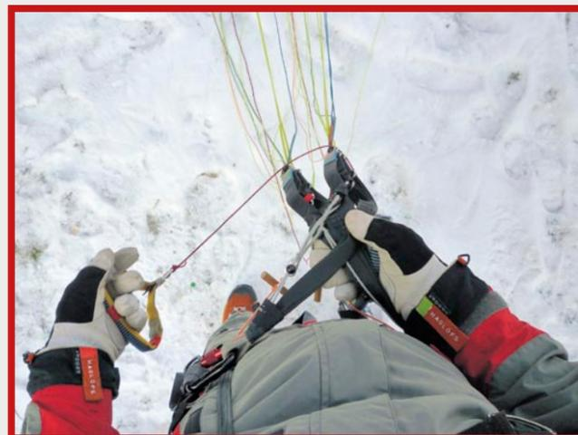
**(6)** Der linke (rot) Tragegurt liegt über dem rechten Tragegurt und die Vorderseiten (A-Gurte) sind wieder oben.
