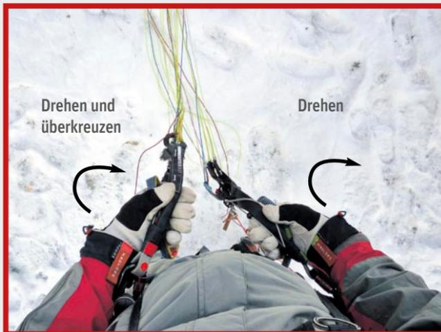
**(5)** Mit den Steuergriffen greifen die Hände den linken und den rechten Tragegurt. Mit einer Rechts-Drehung beider Hände (180° im Uhrzeigersinn) werden jetzt die Tragegurte gedreht und überkreuzt. Die linke Hand überkreuzt die rechte.
