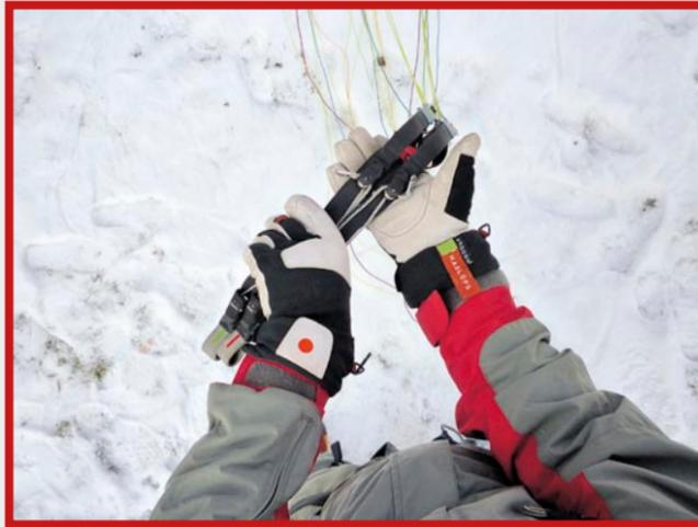
**(1)** Man fasst beide Tragegurte mit der linken Hand von oben und dreht sie um 180° nach links.
