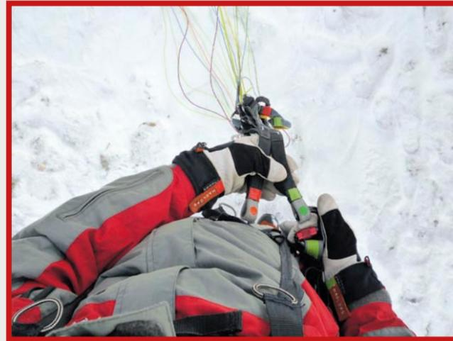
**(2)** Jetzt liegt der rechte Tragegurt rechts und der linke Tragegurt links parallel auf der linken Handfläche. Die Rückseiten (D-Gurte) sind oben. Einfach die Tragegurte rechts und links in die Karabiner einhängen. Tipp: Wenn die Schnapper der Karabiner innen sind, geht's schneller und einfacher.
