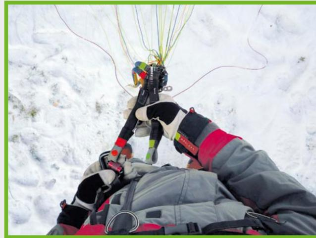
**(2)** Jetzt liegt der rechte Tragegurt rechts und der linke Tragegurt links parallel auf der rechten Handfläche. Die Rückseiten (D-Gurte) sind oben. Einfach die Tragegurte links und rechts in die Karabiner einhängen. Tipp: Wenn die Schnapper der Karabiner innen sind, geht's schneller und einfacher.
