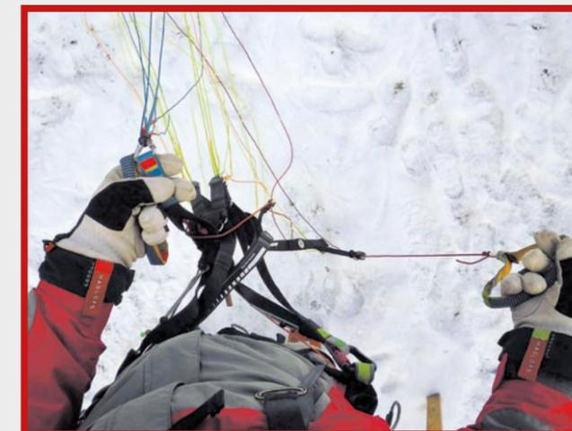
**(7)** Für die Standard Aufziehtechnik werden jetzt beide A-Gurte mit der linken Hand aufgenommen und dann überprüft, ob die linke Steuerleine über den Gurten frei zur Rolle läuft und ob die rechte Steuerleine unterhalb frei zur Rolle führt.
