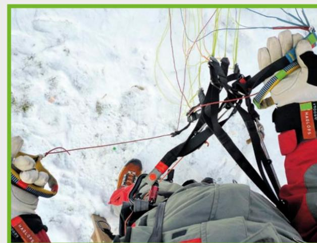
(7) Für die Standard Aufziehtechnik werden jetzt beide A-Gurte mit der rechten Hand aufgenommen und dann überprüft, ob die rechte Steuerleine über den Gurten frei zur Rolle läuft und ob die linke Steuerleine unterhalb frei zur Rolle führt.
