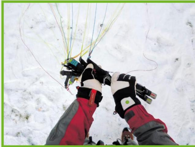
**(1)** Man fasst beide Tragegurte mit der rechten Hand von oben und dreht sie um 180° nach rechts.
