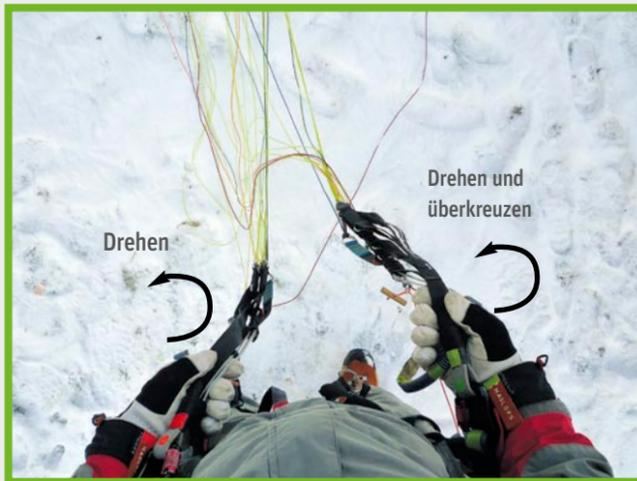
**(5)** Mit den Steuergriffen greifen die Hände den linken und den rechten Tragegurt. Mit einer Links-Drehung beider Hände (180° gegen den Uhrzeigersinn) werden jetzt die Tragegurte gedreht und überkreuzt. Die rechte Hand überkreuzt die linke.
