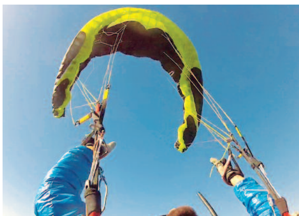
Kleinere Frontklapper öffnen beim Blacklight sehr zögerlich mit einer längeren Phase eingeklappter Flügelenden (Bild links). Große Frontklapper bleiben stabil und können schnell unkontrollierbar werden (Bild rechts). Die aktive Ausleitung über die Bremsen sollte rasch erfolgen, bevor die Schirmkappe verhängt oder in eine Rotation gerät.
