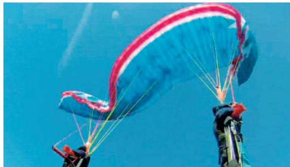
Nova Mentor 3 zeigte im Test keine Tendenzen zu stabilen Frontklappern. Die Öffnung erfolgt relativ schnell, oft leicht asymmetrisch
