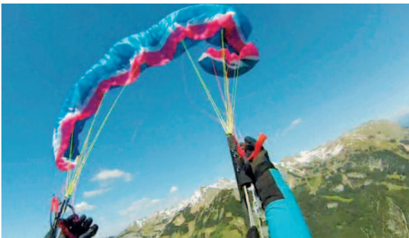
Nova Mentor 3 zeigte im Test keine Tendenzen zu stabilen Frontklappern. Die Öffnung erfolgt relativ schnell, oft leicht asymmetrisch
