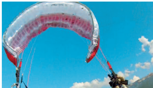
Nova Mentor 3 zeigte im Test keine Tendenzen zu stabilen Frontklappern. Die Öffnung erfolgt relativ schnell, oft leicht asymmetrisch
