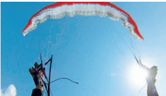
Nova Mentor 3 zeigte im Test keine Tendenzen zu stabilen Frontklappern. Die Öffnung erfolgt relativ schnell, oft leicht asymmetrisch
