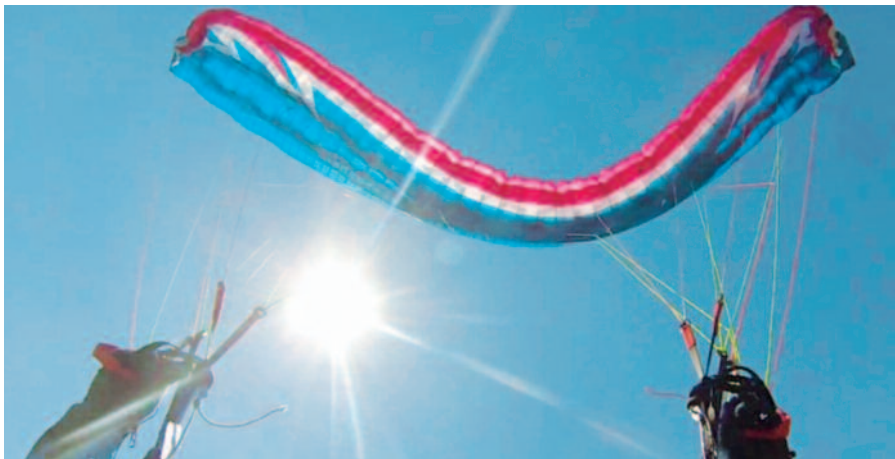
Spart sich die kurze stabile Sinkphase und biegt direkt nach der Einleitung in der Flügelmitte ab: Nova Mentor 3.
