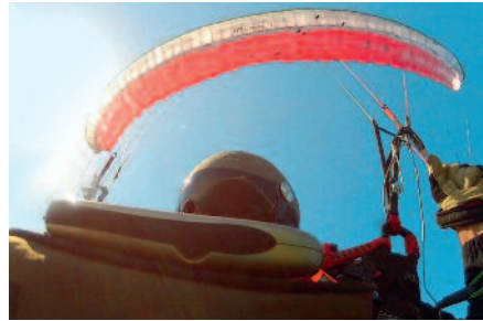
Bleibt nur in kurzer stabiler Sinkphase und biegt dann über die Mitte ab und deformiert sich: Mistral 7.
