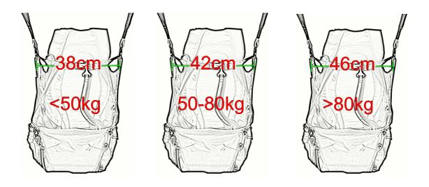
Bei der Prüfung in doppelsitziger Konfiguration wird der horizontale Karabinerabstand des Passagier-Gurtzeugs auf den gleichen Wert eingestellt wie beim Gurtzeug des Piloten. Das Pilotengewicht meint hier das Gewicht des Testpiloten inkl. Ballast.
