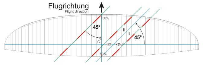
Anmerkung: Alle Angaben sind Prozentangaben der ausgelegten Spannweite und werden an dem flach ausgelegten Gleitsegel bestimmt.
