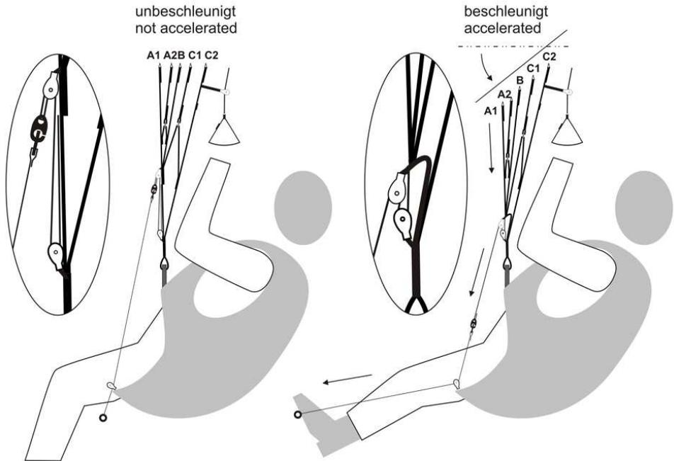
Abbildung 5: Funktionsweise Fußbeschleuniger Stratus 8
