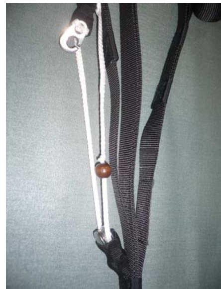
Kugel weiter unten=kürzerer Weg, mehr Kraft
